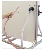
→ Con la válvula de regulación del banco hidráulico cerrada y la válvula de recirculación del banco hidráulico abierta, accionamos el interruptor de la bomba del banco. ¶
