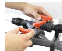
→ Comienza a circular el agua. Con la válvula que tenemos en la parte superior del depósito de salida inferior, regulemos relación agua/aire que queremos en dicho depósito. ¶
